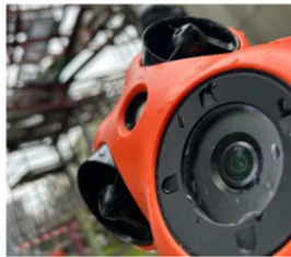
Vue de détail du drone sous-marin avec sa tête de vision
